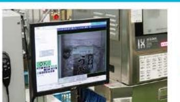
包装後は、安全確認のためにX線や金属検出器で検査します。
