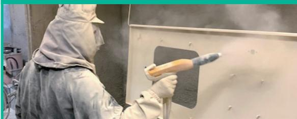
粉の塗料を使います。短時間で塗ることができ、手が届かないなど塗りにくい場所の塗装もできるので、幅広い用途に使われます。
